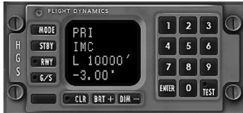
Fig 2.1 Panneau de contrôle du HGS
